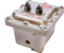
EXAD Caja para interruptor termomagnético, unipolar, bipolar o tripolar con 2 accesos a 180° de 3/4" NPT.
