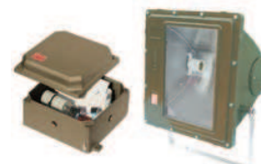
EDAPR + EDPEV Proyector y caja porta equipo para atmosferas de polvos combustibles Ex DIP A 21 para lámparas tubulares o elípticas de vapor de Na y vapor Hg halogenado hasta 400W.
